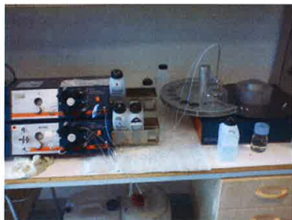
Figur 3. Spektroskopi utrustning som användes vid analyseringen av fosfor och kväve. Fotograf: Albert Gustavsson
