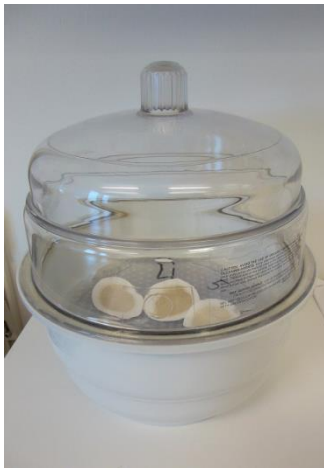
Figur 17 Exsickator med torkmedel för att förhindra uppkomst av fukt. Foto: Julia Andersson
